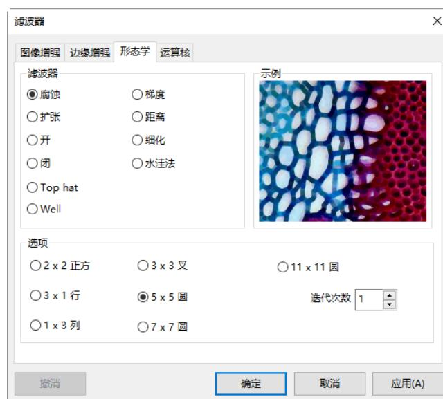
**Well:** 此滤波器探测出图像中比背景色暗的部分并给予加强，选择合适的运算核的大小与你想探测的物体尺寸相匹配以达到最佳的探测效果；
