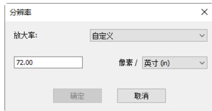
显示当前图像水平**分辨率**, 最终单位为**像素/米**(PPM), 缺省为**x**方向图像分辨率值, 并假定**y**方向图像垂直分辨率同**x**方向一样。
