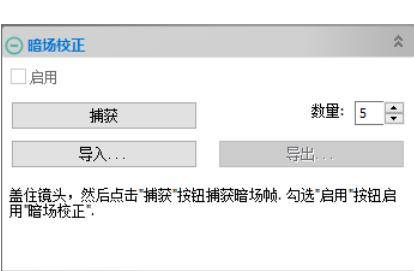
复选/不选择表示**启用**/取消**暗场校正**；单击**导出**按钮将当前**暗场校正**数据导出到 **dfc** 文件供以后用；单击**导入**按钮以前保存在 **dfc** 文件中的**暗场校正**数据以便直接使用。不同分辨率情况下需要重新进行**暗场校正**数据的捕获以确保校正结果正确。
