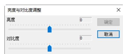
**对比度：**左右调节滑动条可改变图像的**对比度**，其范围在-100 到+100 之间变化，滑动条越靠近左边(-100)则图像**对比度**越小，而越靠近右边则相反。右边的文本框显示的当前的**对比度**值。缺省为0；
