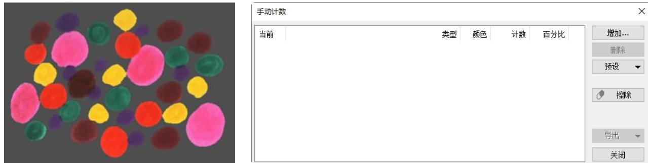
当前对话框列表框为空, 表示没有定义过计数对象。左边待**手动计数**的图像中有 5 个红色的对像
