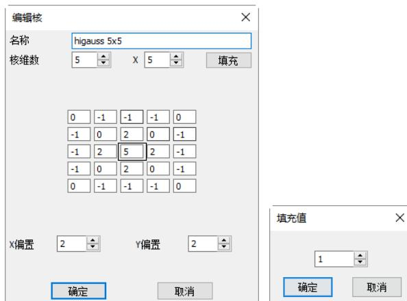
**新建：**新建一运算核，同编辑核对话框是一样如上图所示，在该对话框中可同时指定**核维数**，**名称**，**中心位置**以及每个系数的值等。
