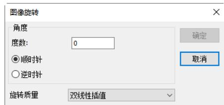
**角度：**设置图像旋转的角度参数等，包括待旋转的具体度数以及旋转的方向等；
