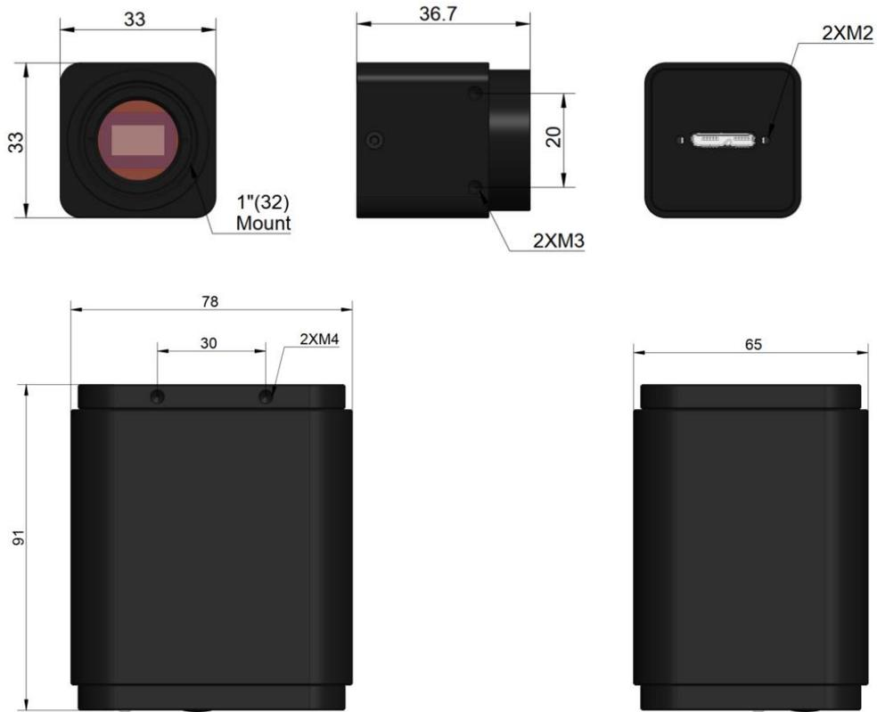
图 3 X5CAM4K\_MR 系列相机尺寸示意图（图像采集子设备与主设备）
