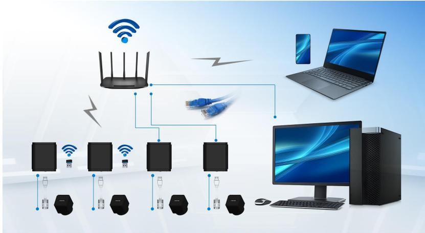
图 11 多台 X5CAM4K\_MR 系列相机通过 LAN/WiFi 连接到路由器
