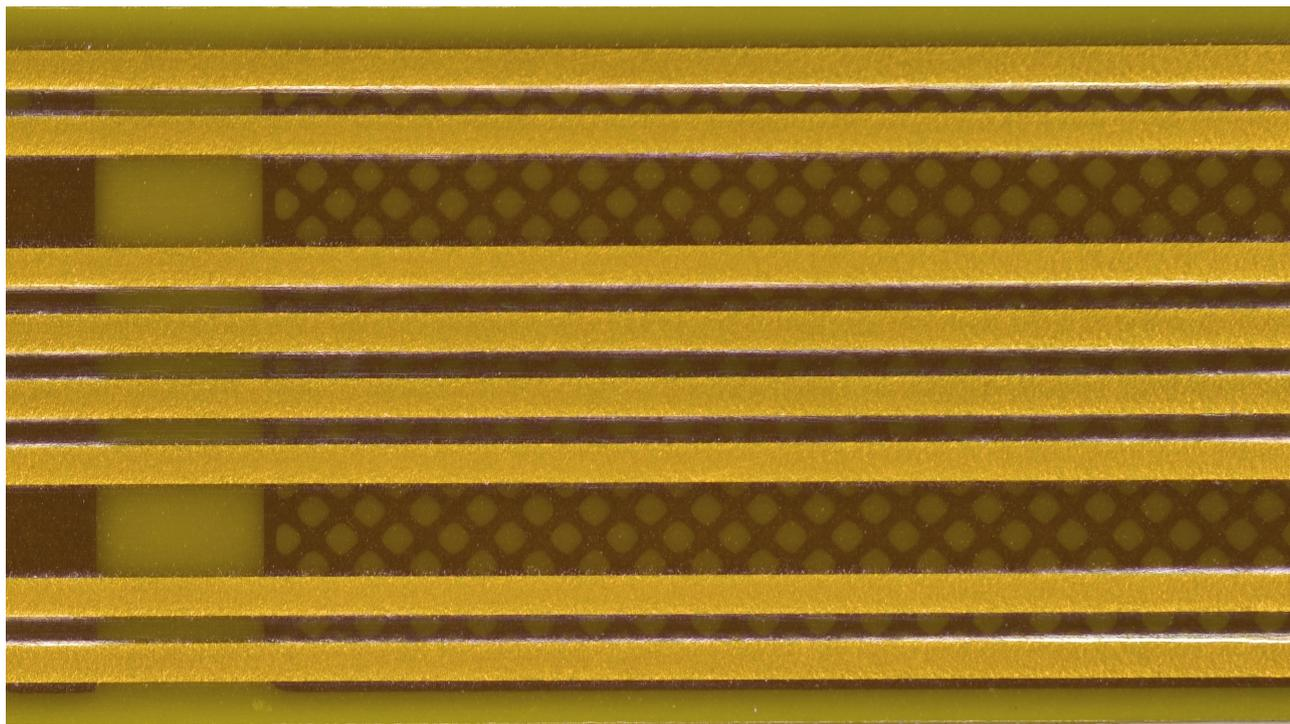
图 35 X5CAM4K8MPA\_MR 拍摄的 FPC 柔性 PCB
